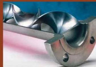
دو پارامتر قابل تغییر در یک استاتیک میکسر سایز و تعداد المان میباشد. معمولا سایز استاتیک میکسر توسط خریدار تعیین میشود و تنها تعداد المانها توسط ما تعیین میشود. و این نیز وابسته به عدد رینولدز سیال میباشد هر چه تعداد المانها بیشتر باشد نتیجه بهتری حاصل میشود.
